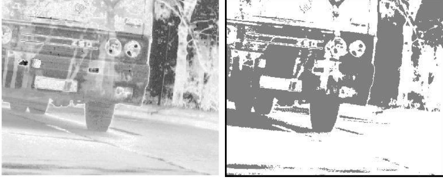
Рис. 4. Результат работы алгоритма, основанного на методах морфологического анализа изображений. Слева: функция d^m(\cdot) — невязка аппроксимации изображения f(\cdot) изображением P_{f_0}f(\cdot) , принадлежащим форме f_0(\cdot) . Справа: множество A^m (выделено белым цветом) — оценка множества A , основанная на d^m(\cdot) .
