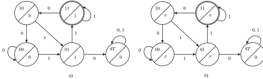
Рис. 5: а) Диаграмма Мура второго рода автомата  $V(010)$ ; б) Традиционная диаграмма Мура автомата  $V(010)$ .
