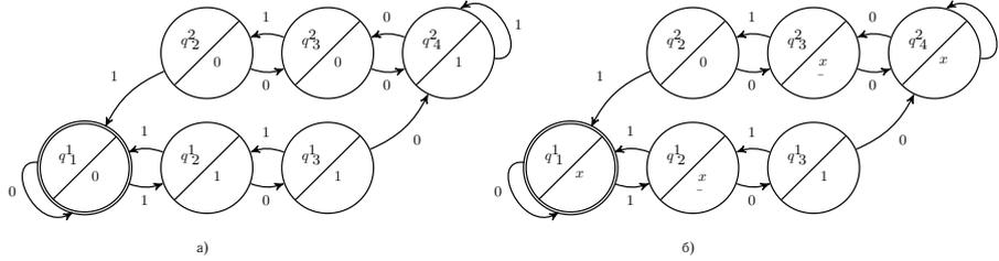
Рис. 4: а) Диаграмма Мура второго рода прогнозирующего автомата.
