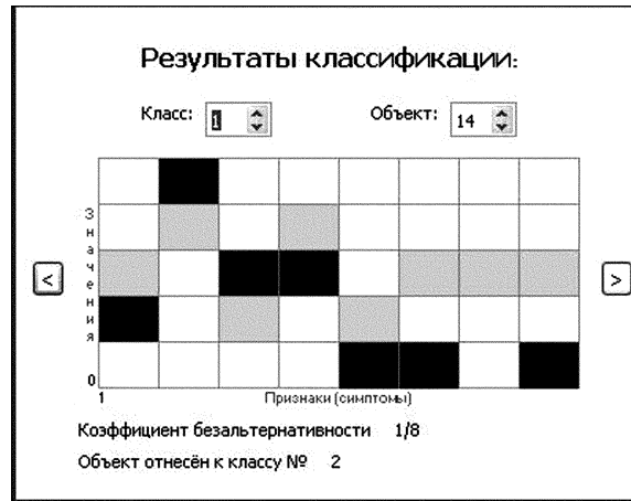
Рис. 8. Гранула второго класса, свойственная 14 объекту первого класса. Значение коэффициента безальтернативности ( 1/8 ) меньше, чем в первом классе ( 4/8 ).
